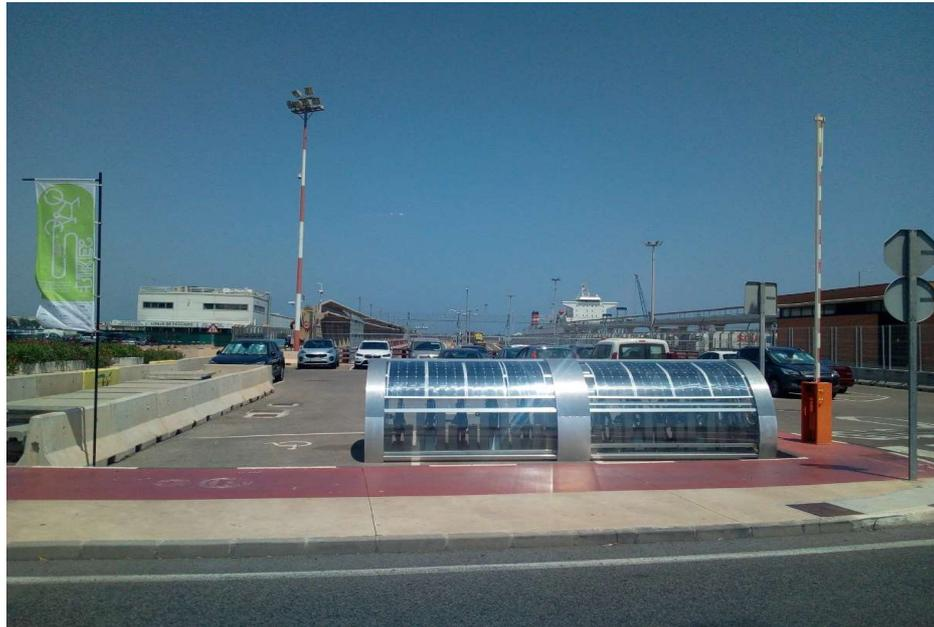
*Parking para bicicletas/VMP autónomo por paneles fotovoltaicos con punto de recarga de vehículos a motor eléctricos*
